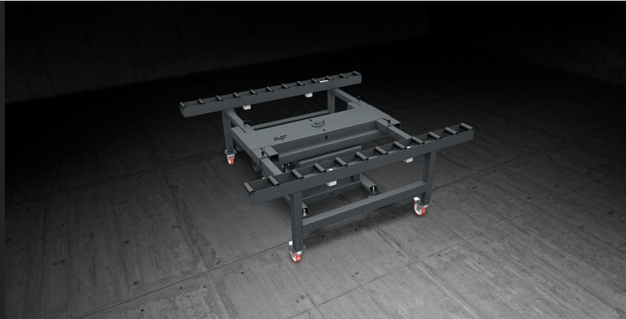
专门用于外墙单元在生产线中装配和移动的模块化工作台，配备两条辊筒轨道，上面覆盖着软质的 PVC 护套；两条轨道之间的距离可根据窗框的宽度进行调整。一个可气动操纵的系统能够在加工阶段锁定辊筒。整个工作台可以 360° 旋转，以方便外墙单元内的组装和密封操作；气动控制器负责锁定角度位置。
