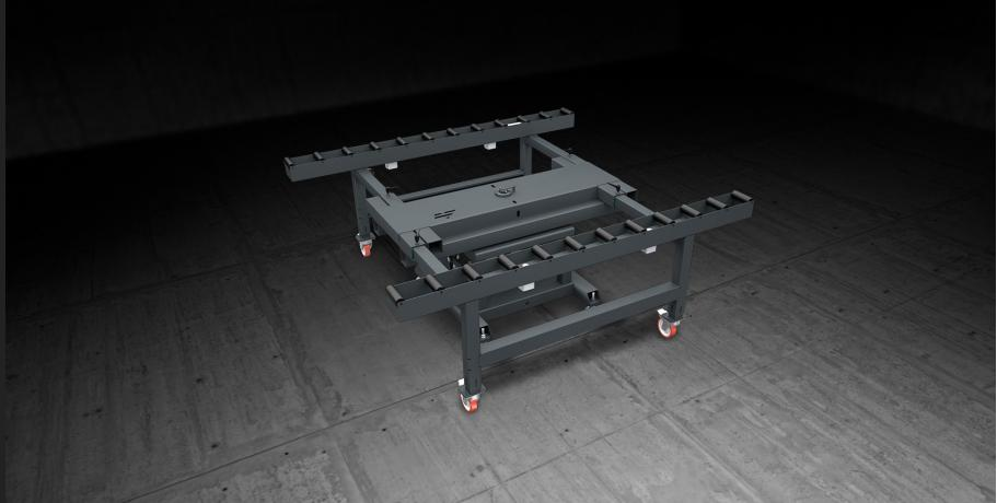
专门用于外墙单元在生产线中装配和移动的模块化工作台，配备两条辊筒轨道，上面覆盖着软质的 PVC 护套；两条轨道之间的距离可根据窗框的宽度进行调整。一个可气动操纵的系统能够在加工阶段锁定辊筒。整个工作台可以 360° 旋转，以方便外墙单元内的组装和密封操作；气动控制器负责锁定角度位置。
