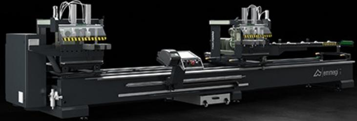
双头切割机配备有移动头、能在循环滚珠轴承导轨上自动移动、专用于切割铁和不锈钢型材。得益于强大而精确的无刷电机、切割机的两个切割头能够从45°转换到135°、并作出相对于垂直轴的所有角度、每一度的精度不低于240个位置、这一特点在本领域堪称一大突破。移动头自动运动、由电子控制：它在导轨和滑板上滑动、从而使机器具有极高的精度和刚度。通过增加切割角的宽度、可将移动头用作自动定位器、从而实现极短工件的加工。此外、还可选择将机器配置为自动切割、通过软件编程执行推裁切割序列、而无需操作员留在控制台上保持激活双手操作按钮。
