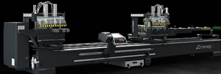
双头切割机配备有移动头、能在循环滚珠轴承导轨上自动移动、专用于切割铁和不锈钢型材。得益于强大而精确的无刷电机、切割机的两个切割头能够从45°转换到135°、并作出相对于垂直轴的所有角度、每一度的精度不低于240个位置、这一特点在本领域堪称一大突破。移动头自动运动、由电子控制：它在导轨和滑板上滑动、从而使机器具有极高的精度和刚度。通过增加切割角的宽度、可将移动头用作自动定位器、从而实现对极短工件的加工。此外、还可选择将机器配置为自动切割、通过软件编程执行推裁切割序列、而无需操作员留在控制台上保持激活双手操作按钮。
