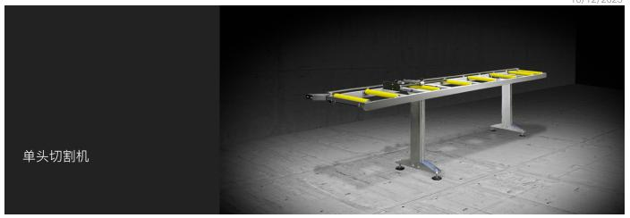
管状钢结构、带有可调节的支脚和 PVC 覆面的刚辊。240 毫米的辊筒、辊筒输送机长度为 3.500 毫米;440 毫米的辊筒、辊筒输送机长度为 4.000 毫米。
