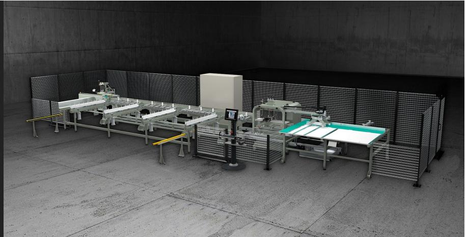
数控切割中心具有 3 个控制轴，全自动，专门用于切割铝、PVC 和一般轻合金型材。V-CUT，从挤出的型材棒开始，自动加载、切割和卸载经过预定义和优化的切割清单。设计用于 45° 至 135° 或 22°30' 至 157°30' 角度的切割。
