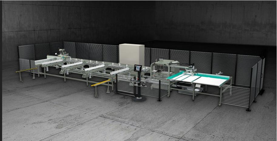
数控切割中心具有 3 个控制轴，全自动，专门用于切割铝、PVC 和一般轻合金型材。V-CUT，从挤出的型材棒开始，自动加载、切割和卸载经过预定义和优化的切割清单。设计用于 45° 至 135° 或 22°30' 至 157°30' 角度的切割。
