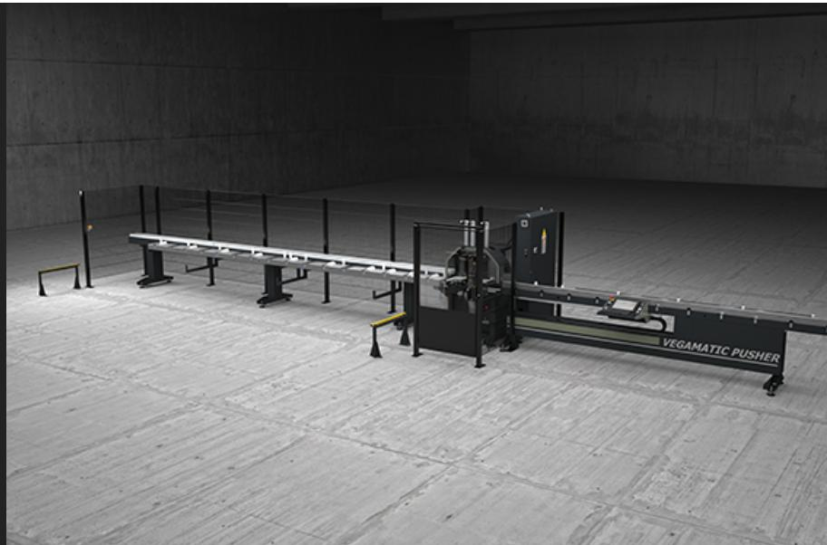
半自动版本的切割中心有 2 个控制轴、在机床的相对两侧进行手动的装卸料、正面数控刀片专门用于切割铝、PVC 和一般轻合金型材、能够自动进行预设定、优化的切割清单。设计用于在 45° 至 135° 或 22°30' 至 157°30' 的角度范围内进行切割。可以与垂直或水平钻孔单元配套、来进行特殊自动加工。
