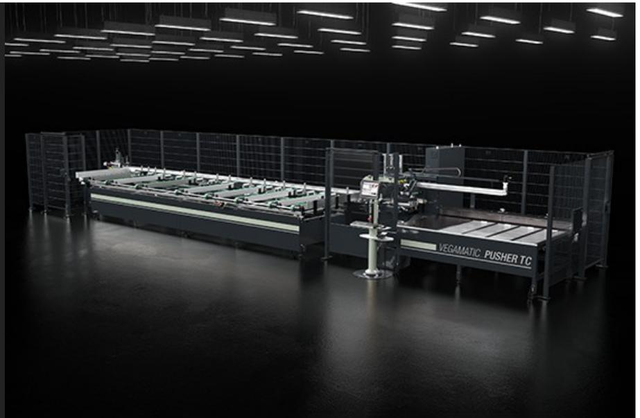
半自动切割中心、配有 CNC 控制的正面刀片、3 个被控制的轴、适合于切割铝合金、PVC 和普通轻合金型材。能够自动进行预设、优化的切割程序。在型材的两个断面可以进行倒角切割。此机器用于  $45^\circ$  至  $135^\circ$  或  $22^\circ30'$  至  $157^\circ30'$  角的切割。棒材自动装载装置和对侧的自动卸料仓可以与垂直或水平钻床配套、来进行特殊自动加工。
