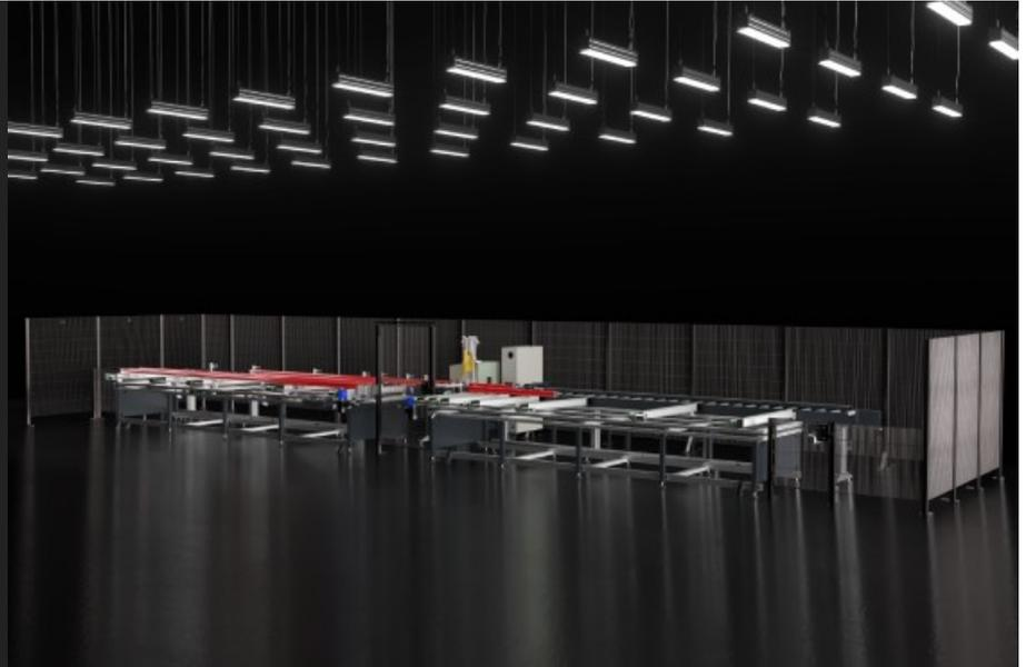
90° 切割中心专门用于切割铝型材束。切割中心由几个不同的单元组成，这些单元相互连接，仅需一名操作员即可完全管理工作周期，从装载阶段到卸载阶段按尺寸切割的型材束。在受电弓升降机（选配）的帮助下，操作员可以将型材束放在装载台上，逐步累积操作（最多 4 – 5 束）。然后，电动辊筒运输机将型材束带到切割单元，切割单元进行初始的型材束端面铣削以及随后的尺寸切割（工作周期由软件设定）。切割废料通过安装在切割单元上的中央辊筒输送机自动卸载。另一方面，型材束的下脚料通过卸载台辊筒输送机从切割区疏散出来，并由皮带抬起，由操作员手动卸载。
